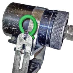
Abb. 10: Am Lampenkopf fixierte Bungee-Schlaufe seitlich (zum verstauen des Lampenkopfes)
