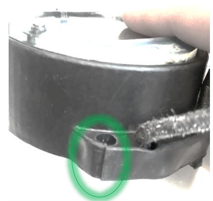
Abbildung 6: ausgerissenes Loch am Bungee-Mount
